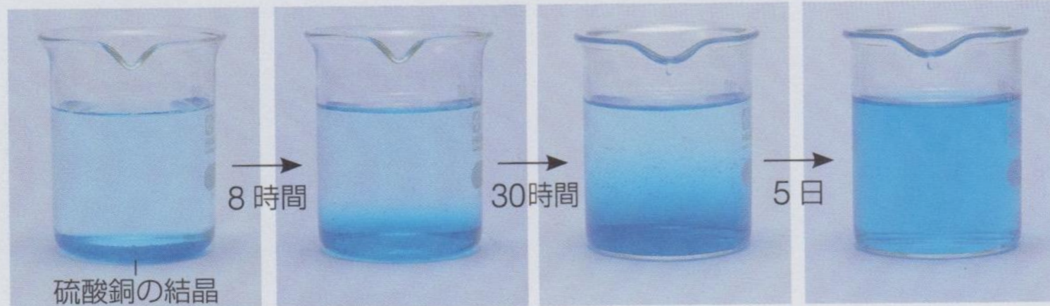
図 1 硫酸銅が水に溶解するようす
