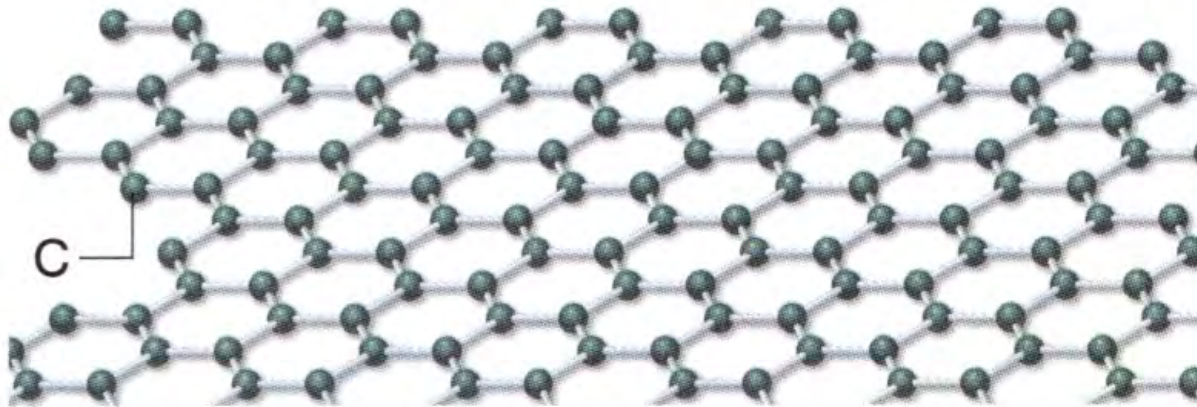
グラフェン・レイヤーの構造
