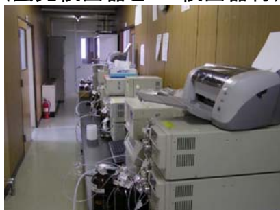
高速液体クロマトグラフィー HPLC (蛍光検出器とUV検出器付)
